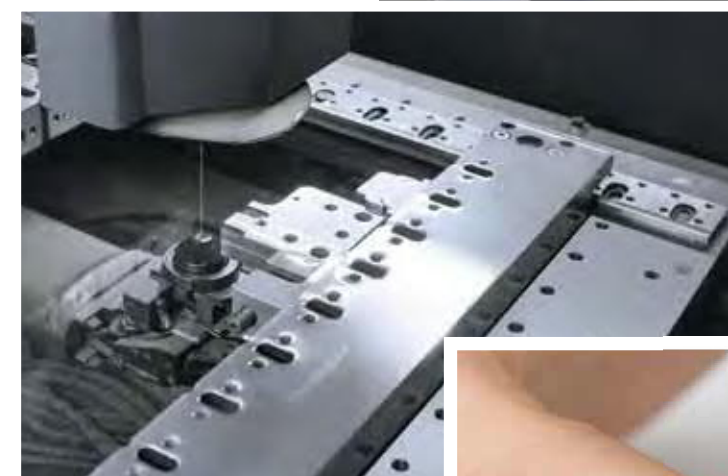
Schneidstempel für einen 0,3-mm-Schneidspalt sind auf den Mitsubishi Electric Erodiersystemen kein Problem.
